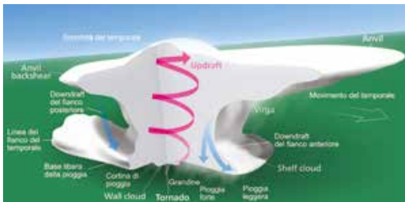
Figura 48 Schema della struttura di un temporale supercella con la posizione del tornado.
